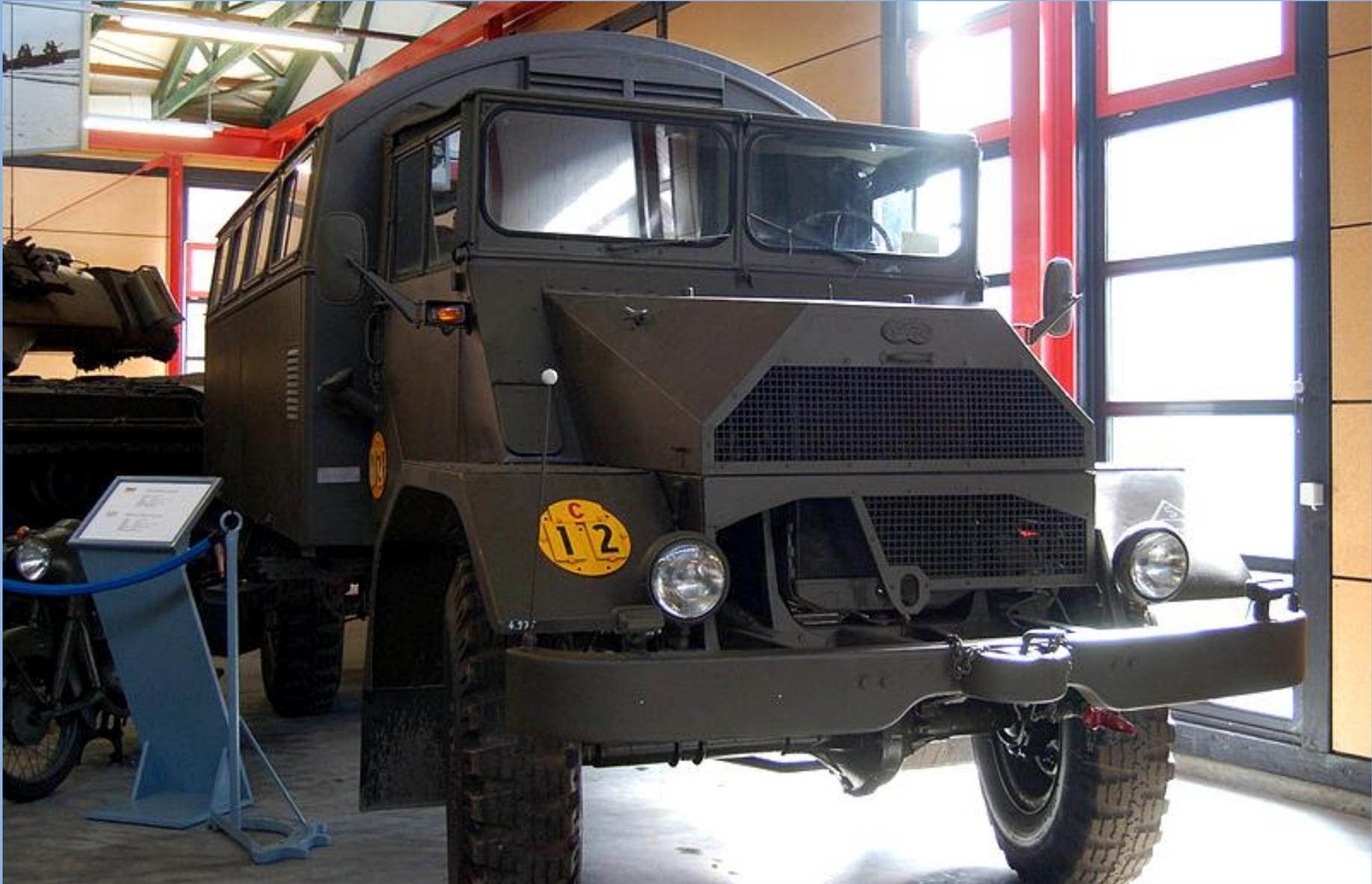
**Der Lastkraftwagen 3 t gl (4 x 4) Ford 398 SAM (Natoziege) Besatzung: 1 + 2 Soldaten, gehörte auch zur Ausstattung der mittleren Instandsetzungskompanie 12.**
