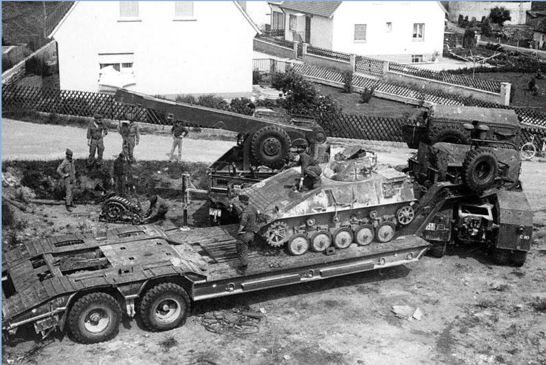
**Bergung eines Schützenpanzers SPz kurz Hotchkiss auf einem Tieflader mit Faun-Zugmaschine.**
