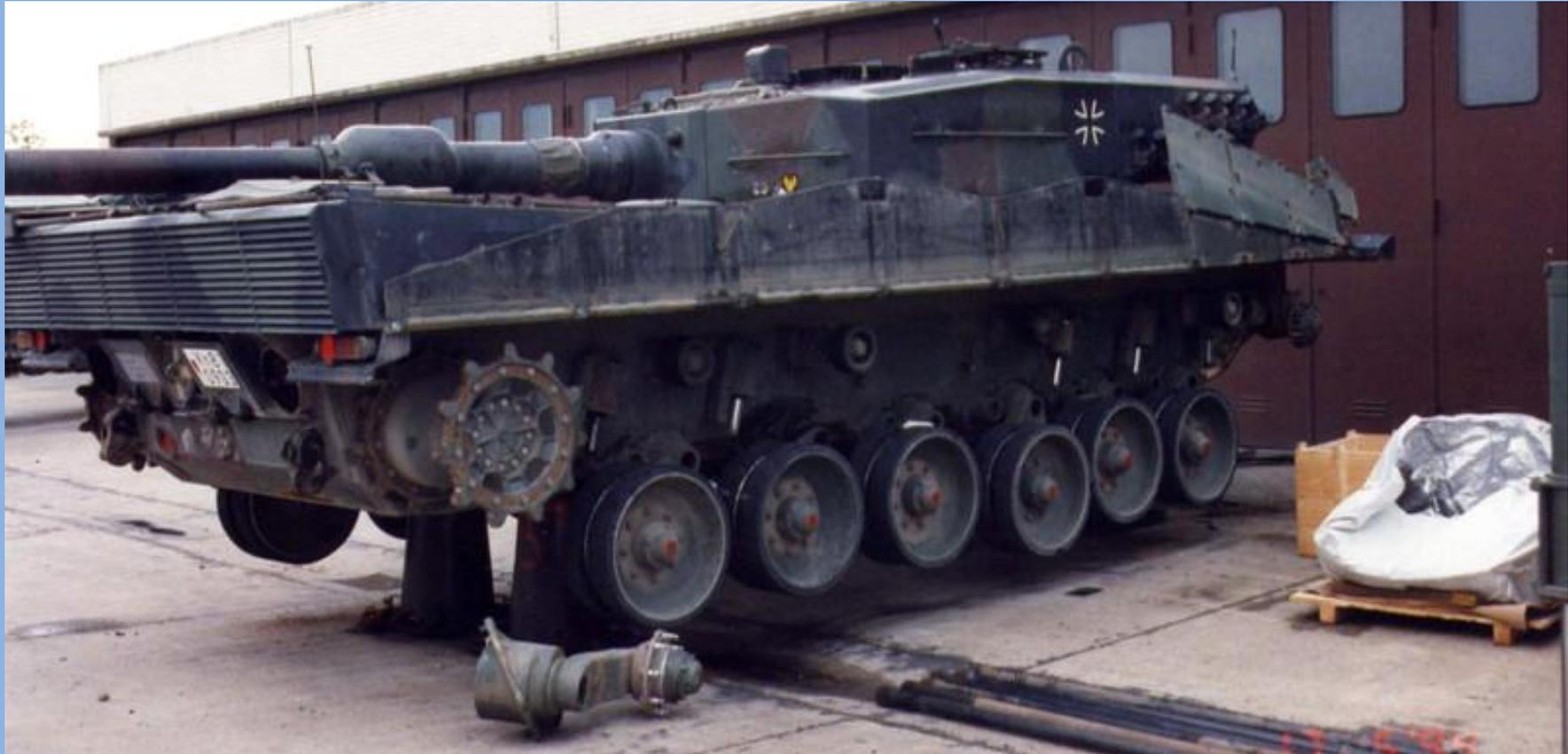
**Instandsetzung am Laufwerk eines Leopard 2A4.**
